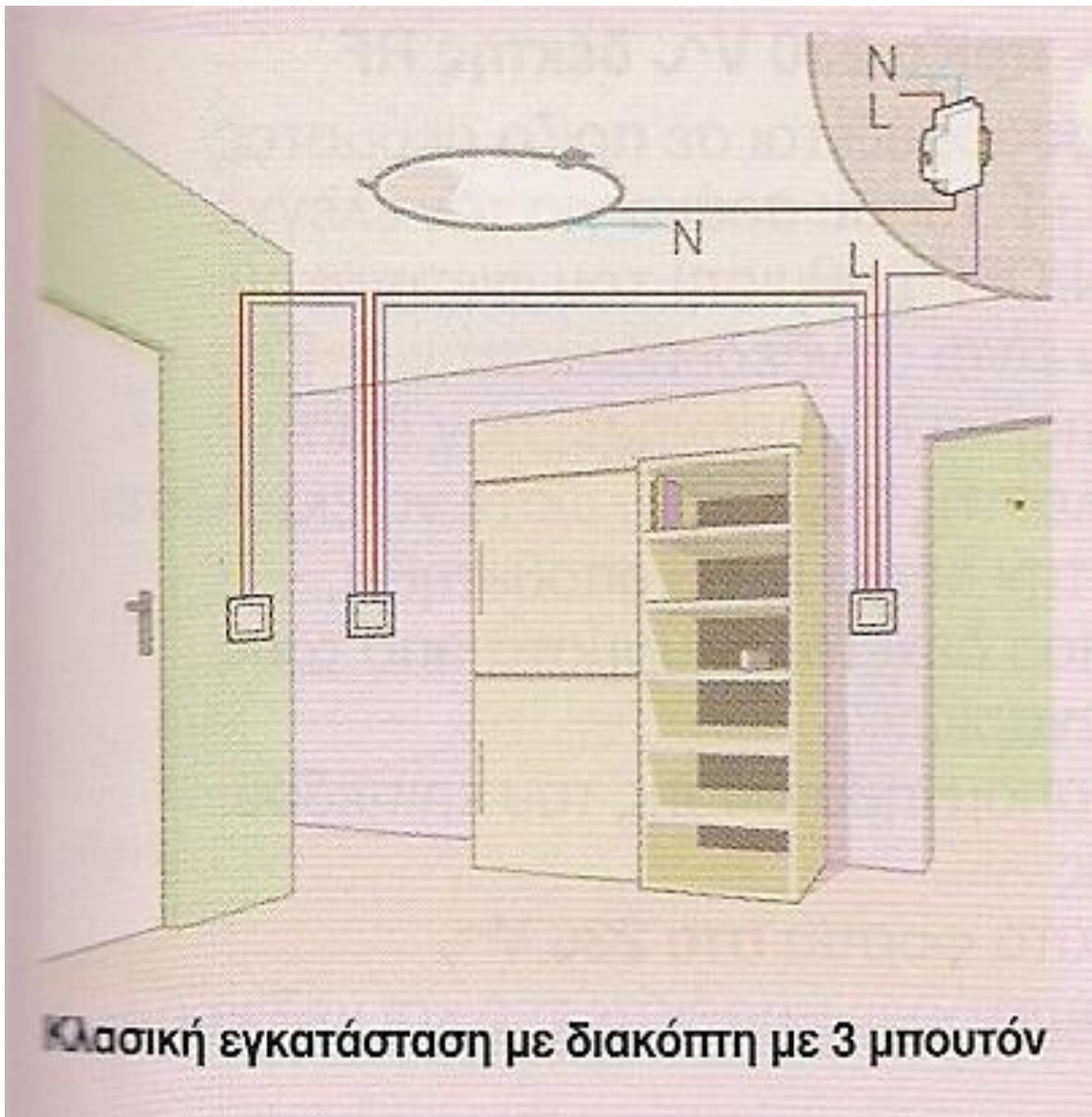
Εικόνα 23: Εγκατάσταση με διακόπτη με 3 μπουτόν
