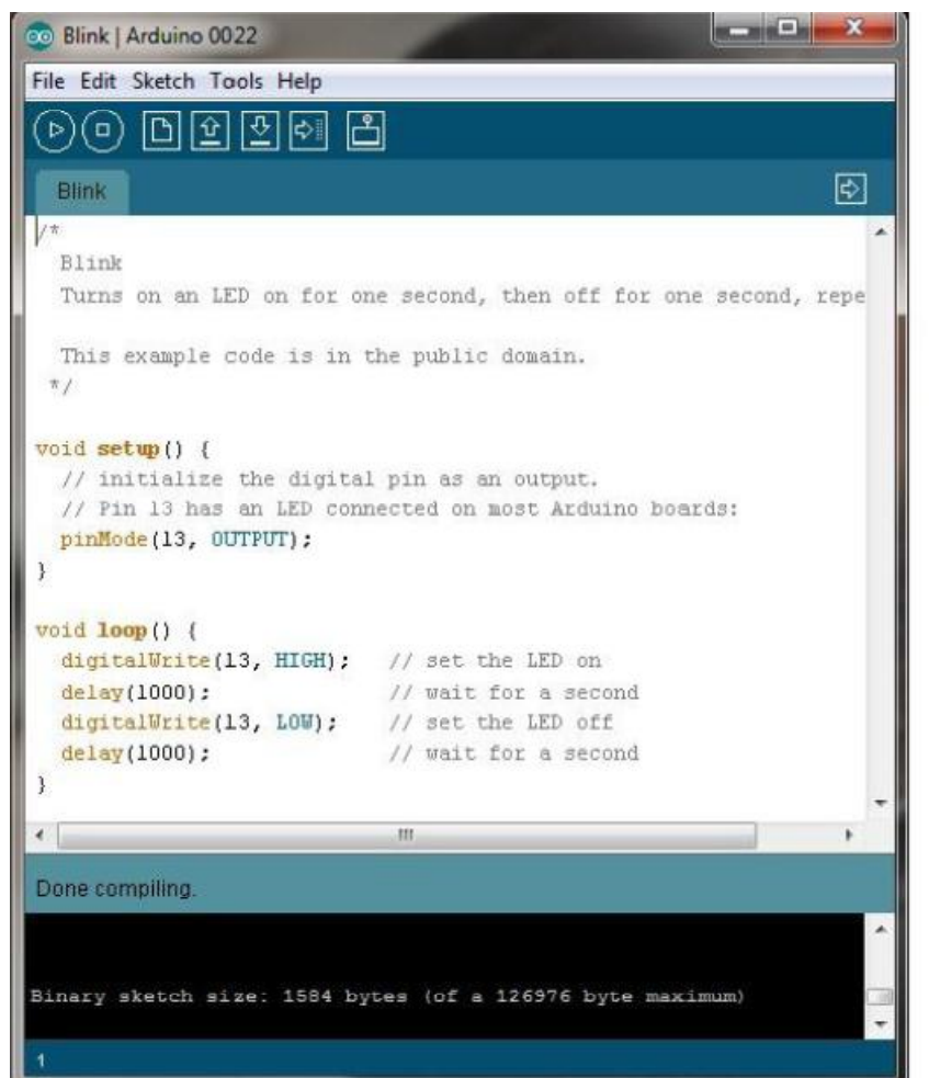
Εικόνα 2. Το ολοκληρωμένο περιβάλλον ανάπτυξης (IDE) του Arduino
