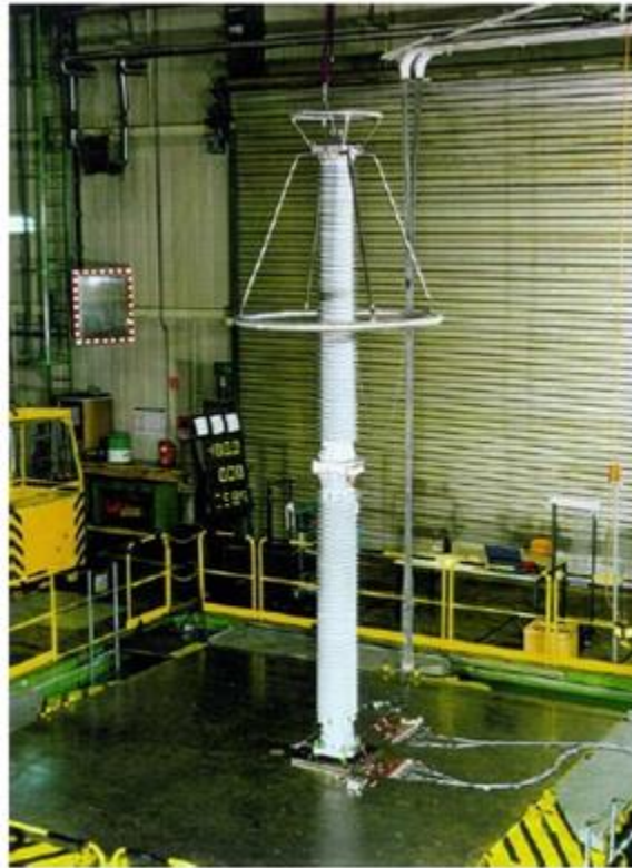
Εικόνα 44: Αλεξικέραυνο με πολυεστερικό περίβλημα για ένα σύστημα 550 kV κατά τη διάρκεια τεστ σεισμού πάνω σε ένα κινούμενο τραπέζι.
