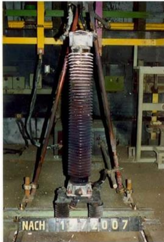
Εικόνα 45: Αλεξικέραυνο με πορσελάνινο περίβλημα
