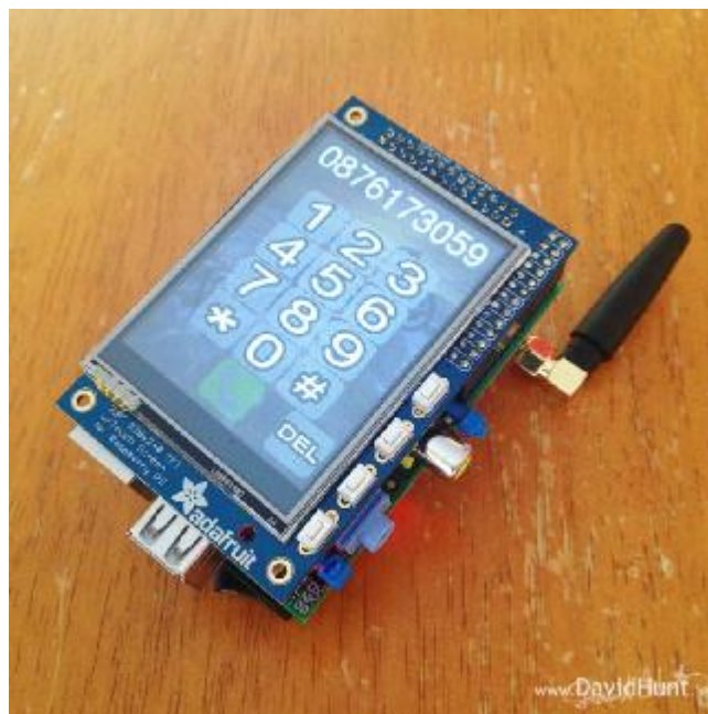
Εικόνα 20: Το κινητό PiPhone, βασισμένο στο Raspberry Pi (PC Magazine, 2014)
