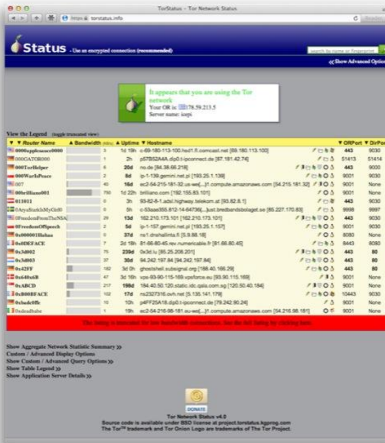
Εικόνα 21: Έλεγχος καλής λειτουργίας του relay μέσω του http://torstatus.info (Hacker, 2013)
