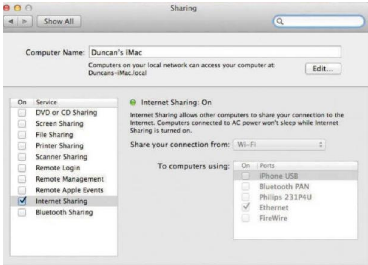
Εικόνα 14: Διαμοιρασμός πρόσβασης στο Διαδίκτυο μεταξύ υπολογιστή με Mac και Pi (Asadi et al., 2014)
