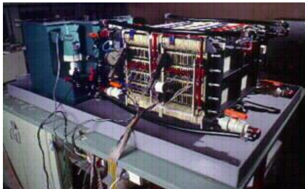
Σχήμα 2.4: Εφεδρικό σύστημα μπαταριών βαναδίου αμυντικής έκτακτης ανάγκης.
