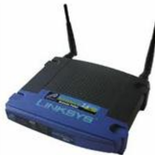
Εικόνα 2.2: Wi - Fi Access point
