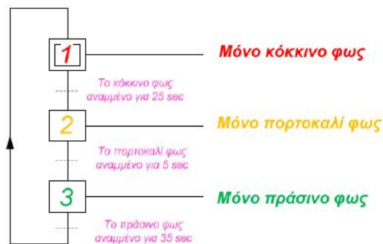
Σχ.3.8.δ: Έλεγχος τρίχρωμου φωτεινού σηματοδότη σε γλώσσα SFC.
