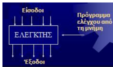
Εικ.3.1.α: Απλοϊκή σχεδίαση τρόπου λειτουργίας του ελεγκτή.
