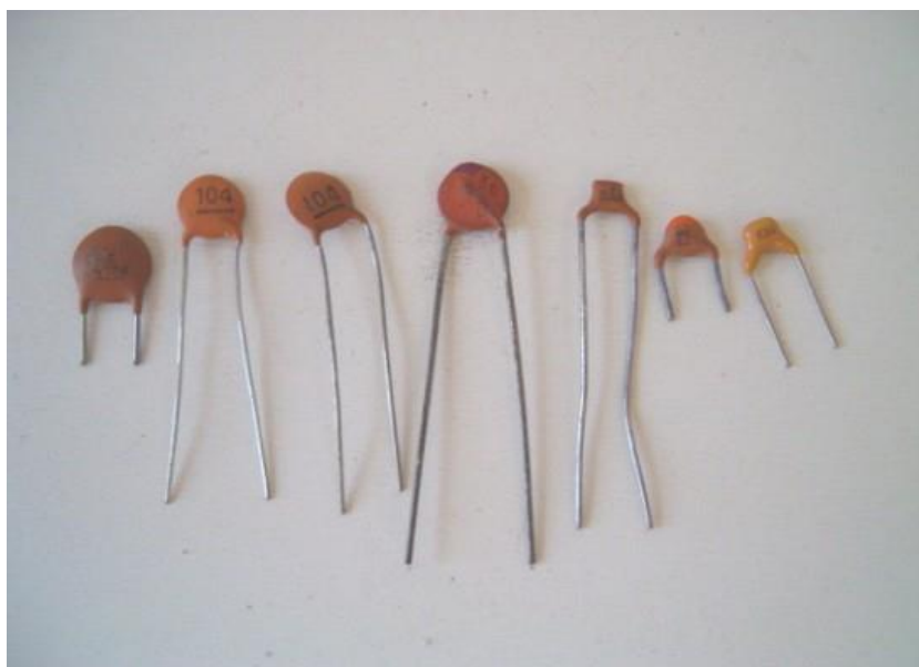
5.1. Κεραμικοί πυκνωτές διαφόρων χωρητικότητων χαμηλών τάσεων λειτουργίας.
