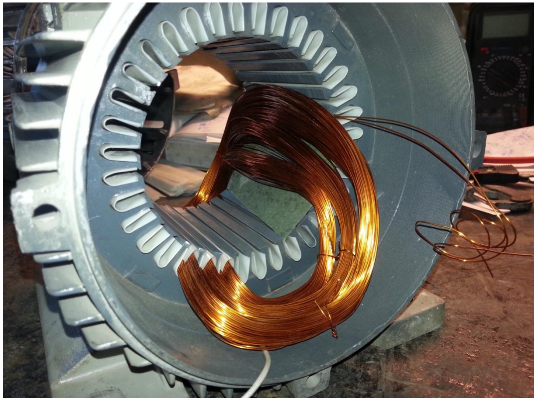
Εικόνα 15: Η τοποθέτηση του πρώτου τυλίγματος στο στάτη
