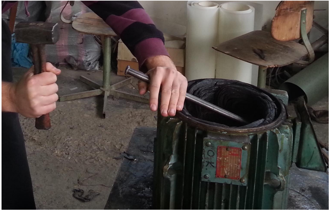
Εικόνα 11: Ο τρόπος με τον οποίο αφαιρέθηκε το καμένοτύλιγμα από την μια πλευρά.
