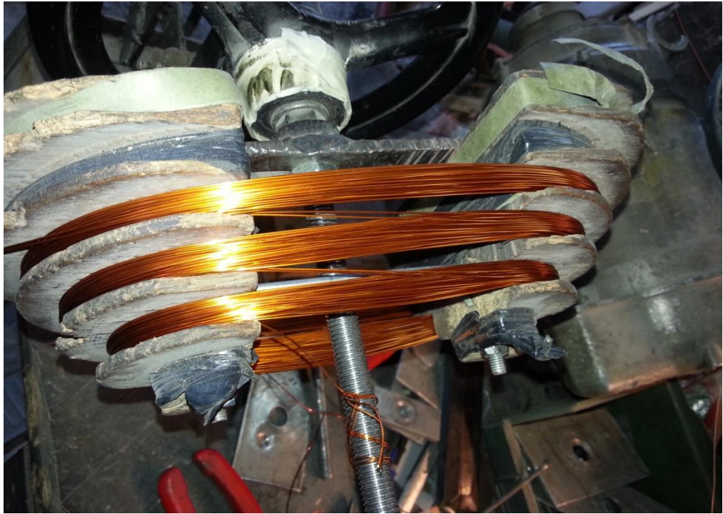
Εικόνα 14 : Η δημιουργία των πρώτων τυλιγμάτων πάνω στο καλούπι.
