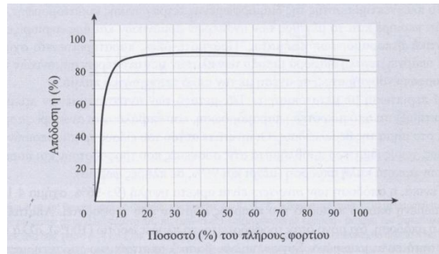
Σχήμα 5.7. Μεταβολή της απόδοσης του inverter σε συνάρτηση με το ποσοστό του πλήρους φορτίου που τροφοδοτεί. [8]
