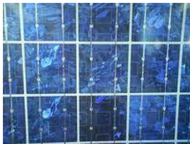
Σχήμα 3.5. Σχηματική απεικόνιση Φ/Β στοιχείου πολυκρυσταλλικού πυριτίου. [8]
