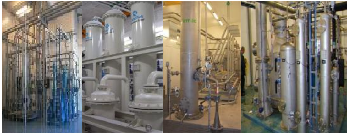
Εικόνα 7: Μονάδες αναβάθμισης βιοαερίου στη Σουηδία (Πηγή: Owe Jonsson, Swedish Gas Center)
