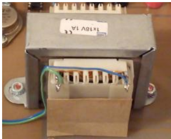
Σχήμα 3.1 Ο μετασχηματιστής που χρησιμοποιήθηκε για την τροφοδοσία του κυκλώματος παλμοδότησης.
