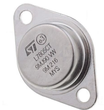
Σχήμα 3.4 Το σταθεροποιητικό τάσης L7805CT της εταιρείας STMicroelectronics.
