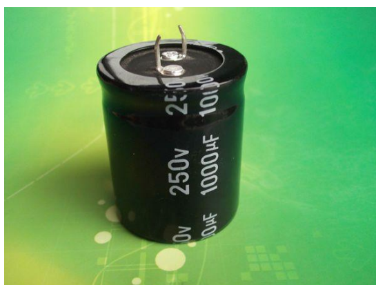
Σχήμα 3.17 Ο ηλεκτρολυτικός πυκνωτής που χρησιμοποιήθηκε στην έξοδο της ανορθωτικής γέφυρας ισχύος του μετατροπέα με σκοπό την μείωση των υπερτάσεων πάνω στο IGBT.
