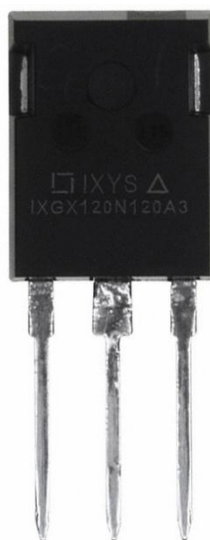
Σχήμα 3.11 Transistor της εταιρείας IXYS. Από αριστερά προς τα δεξιά η διάταξη των pins είναι ως εξής: G (Gate), C (Collector), E (Emitter).
