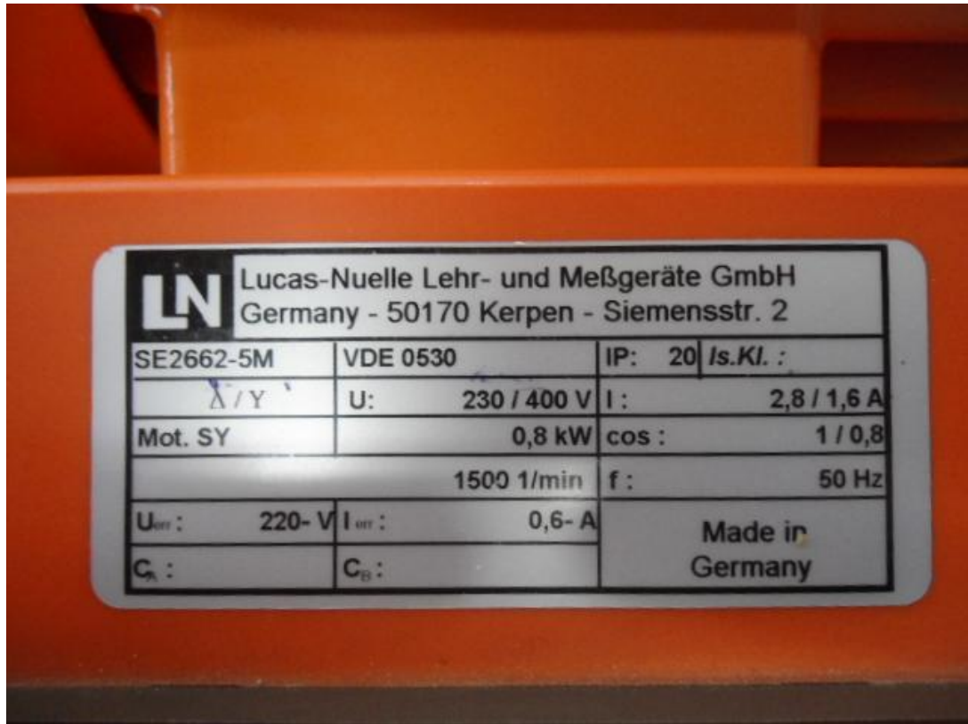
Σχήμα 4.25 Η πινακίδα του κατασκευαστή της σύγχρονης γεννήτριας.
