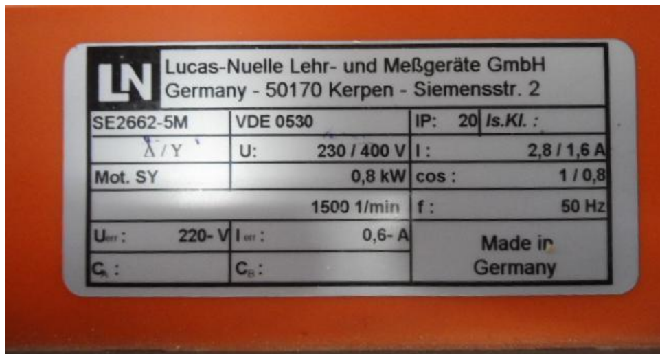
Σχήμα 4.27 Η πινακίδα του κατασκευαστή της σύγχρονης γεννήτριας.
