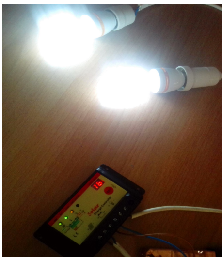
Σχήμα 3.7 – Ελεγκτής Φόρτισης και Καταναλώσεις την Περίοδο των Μετρήσεων
