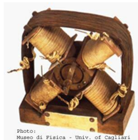
Σχήμα 1.1 Ο επαγωγικός κινητήρας όπως κατασκευάστηκε από τον G. Ferraris
