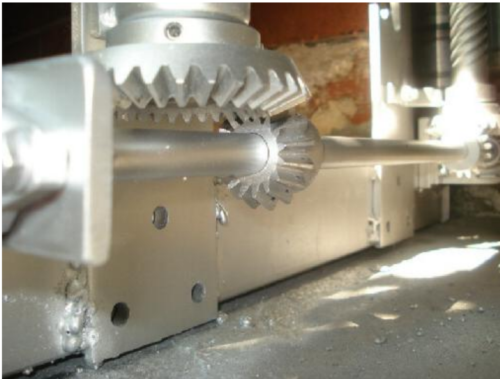
Σχήμα 2.9 Μηχανικός μειωτήρας με γωνιακά γρανάζια για την αλλαγή κατεύθυνσης και την μείωση της ταχύτητας περιστροφής
