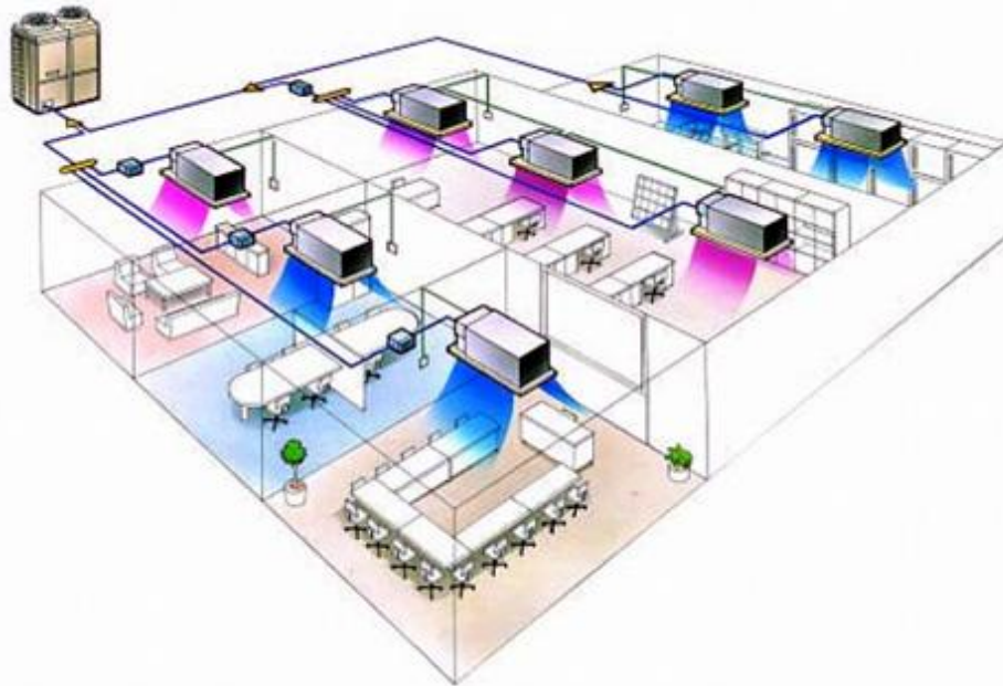
Σχήμα:4:10: Εγκατάσταση συστήματος VRV σε κτίριο
