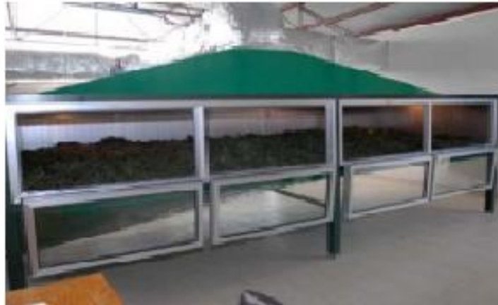
Σχήμα 1.4: Υβριδικό ξηραντήριο αρωματικών φυτών στο Βοτανόκηπο Αθαλάσσας
