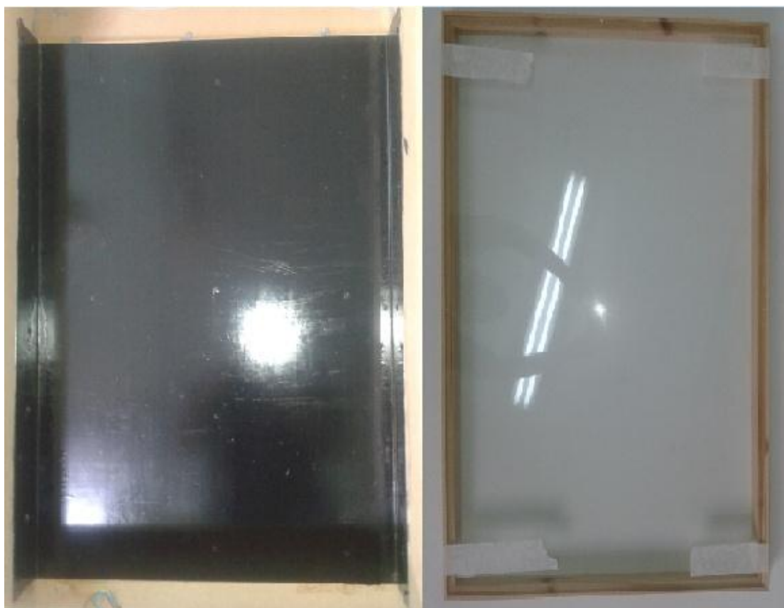
Σχήμα 2.3: Ανακλαστήρας και ξύλινο πλαίσιο με το τζάμι
