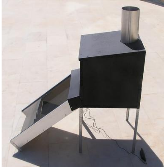
Σχήμα 1.3: Ηλιακό ξηραντήριο έμμεσου τύπου που κατασκευάστηκε από το τμήμα φυσικών πόρων και περιβάλλοντος του ΤΕΙ Κρήτης.
