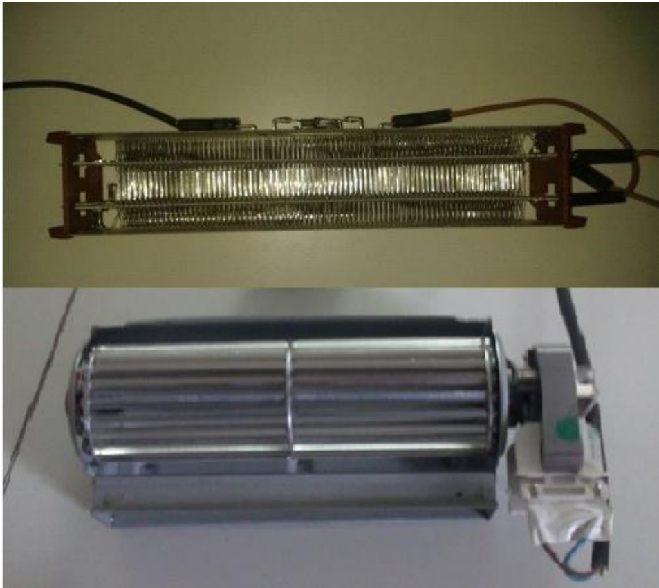
Σχήμα 2.5: Αντίσταση τύπου κτένα και Βεντιλατέρ
