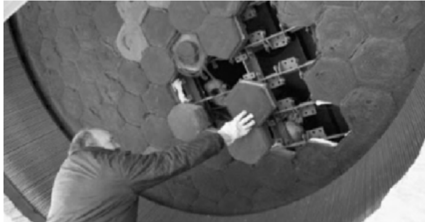
Σχήμα 30 Παράδειγμα Ογκομετρικού Δέκτη ,από το Πείραμα TSA στην Ηλιακή Πλατφόρμα της Αλμερίας. [20]
