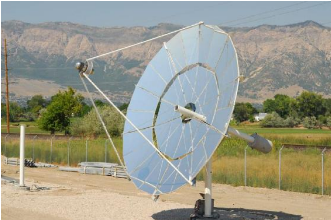
Σχήμα 45 Ενεργειακό ηλιακό σύστημα της εταιρείας Infinia [35]
