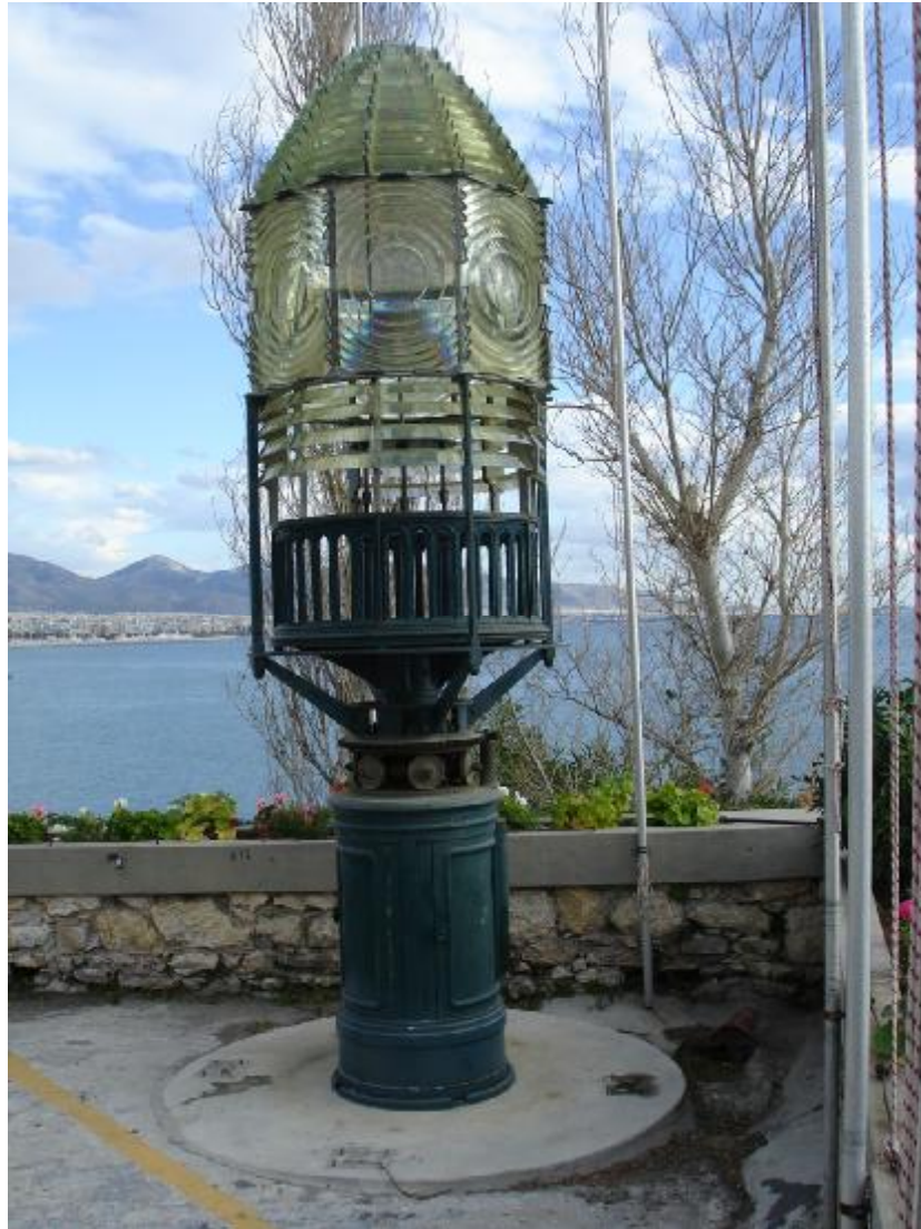
Σχήμα 51 Φαρικό οπτικό (μηχανή) τύπου Φρενέλ όπου διακρίνονται οι επάλληλοι οριζόντιοι (πάνω και κάτω) και κάθετοι ομόκεντροι δακτύλιοι (διοπτρικά στοιχεία) περιμετρικά. [44]
