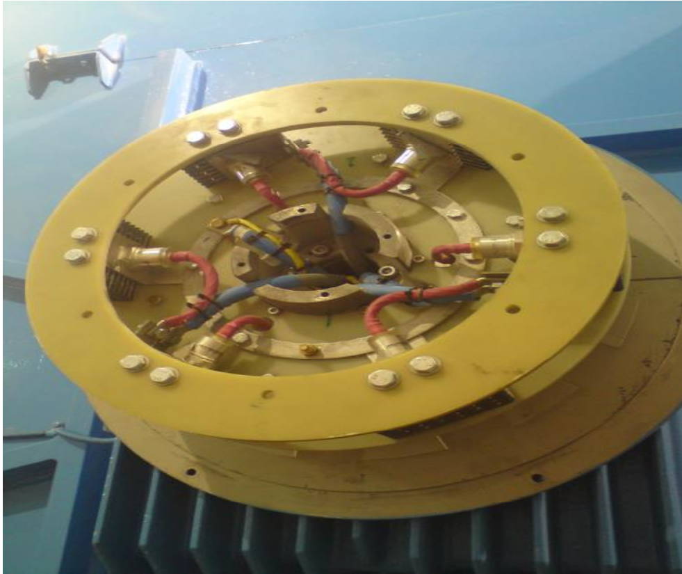
Η περιστρεφόμενη ανορθωτική γέφυρα – με τις έξι διόδους – της γεννήτριας
