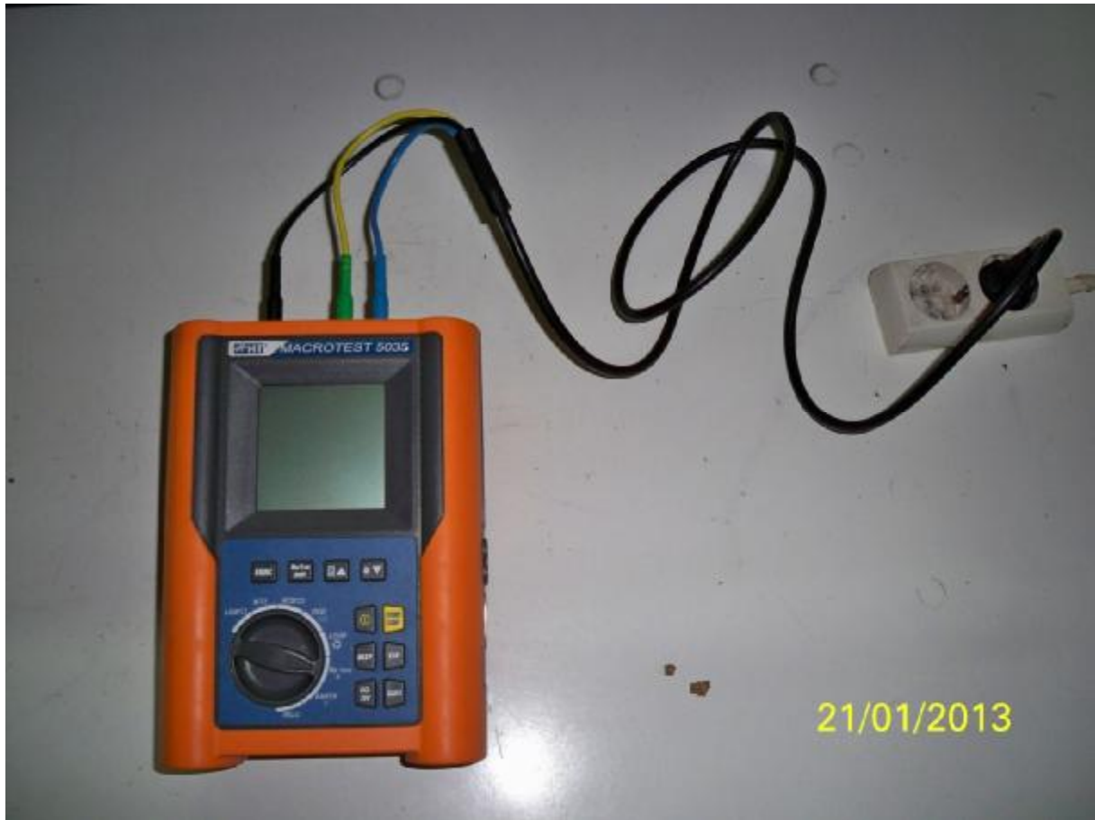
Εικόνα 6.9 μέτρηση σύνθετης αντίστασης βρόχου σφάλματος και ρεύματος βραχυκυκλώματος για P-PE
