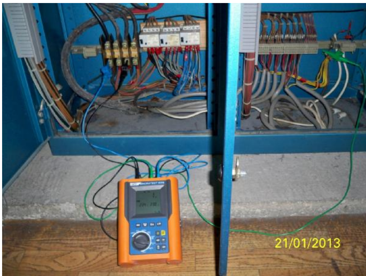
Εικόνα 6.11 Μέτρηση συνολικής αντίστασης γείωσης με ρεύμα 15mA
