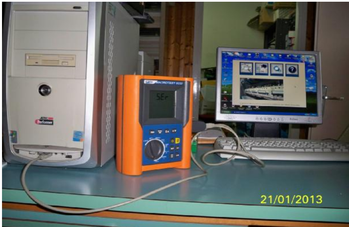
Εικόνα 6.12 Σύνδεση οργάνου με τον υπολογιστή.
