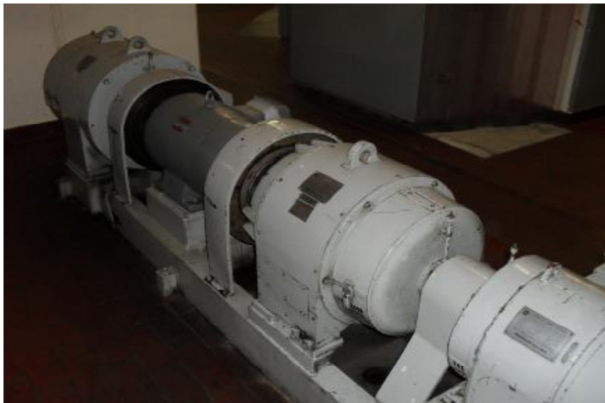
(ΕΙΚ.ΜΑΓΝΗΤΟΗΛΕΚΤΡΙΚΗ ΜΗΧΑΝΗ P.M.G)
