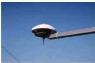
Εικόνα 5-1 Το πυρανόμετρο με το οποίο έγιναν οι μετρήσεις της ηλιακής ακτινοβολίας
