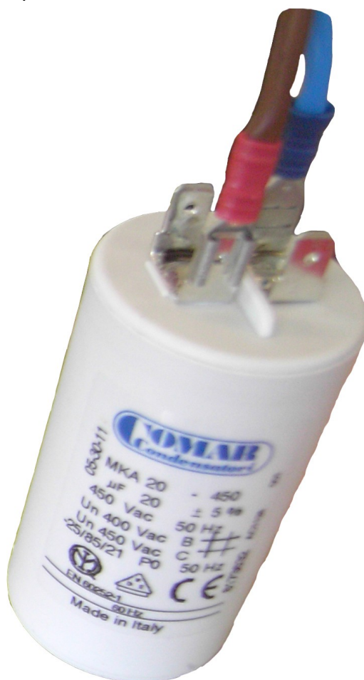
Σχήμα 20 : Ο πυκνωτής στην έξοδο του μετατροπέα
