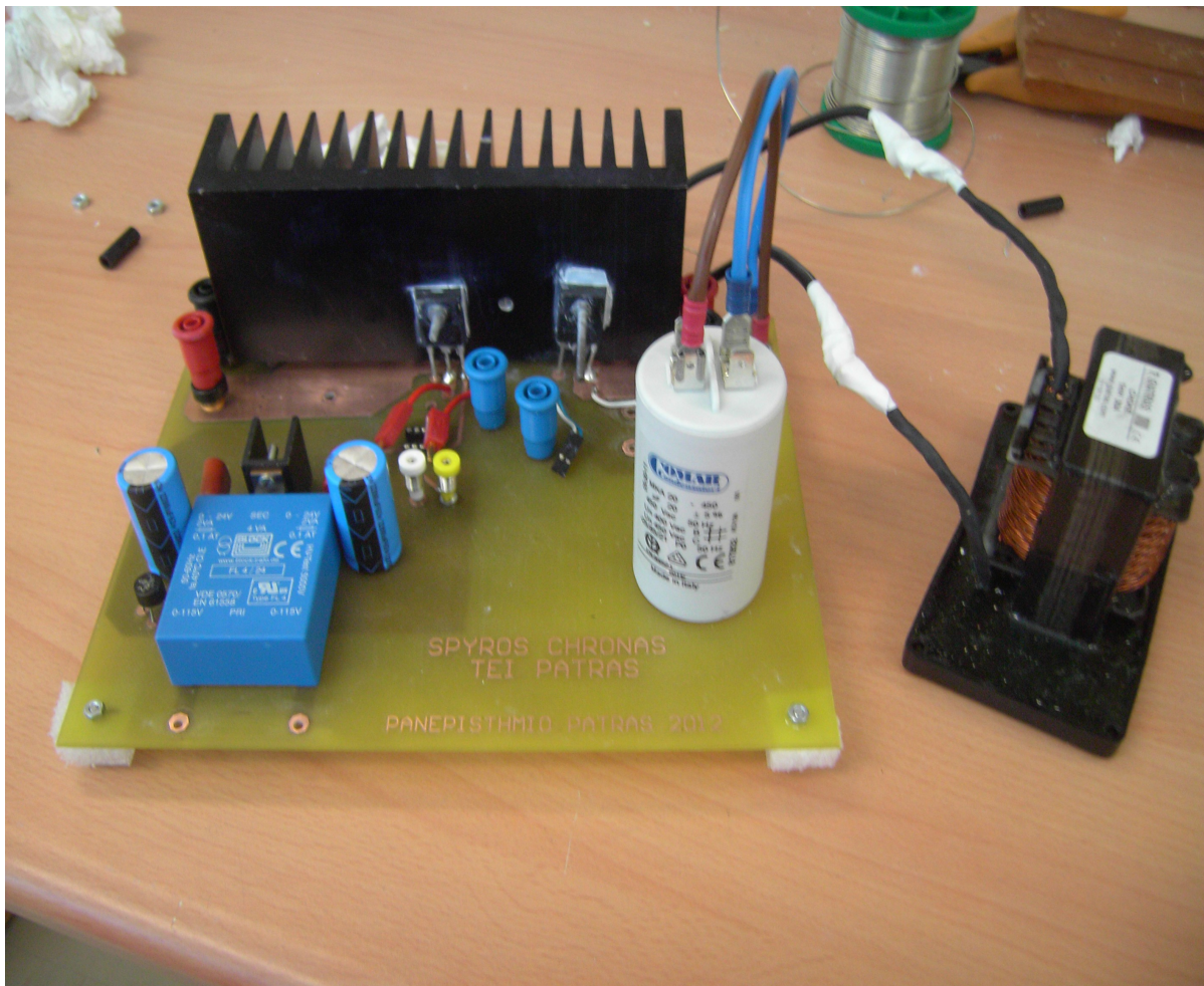
Σχήμα 30 : Η ολοκληρωμένη πλακέτα του DC Buck/Boost μετατροπέα.
