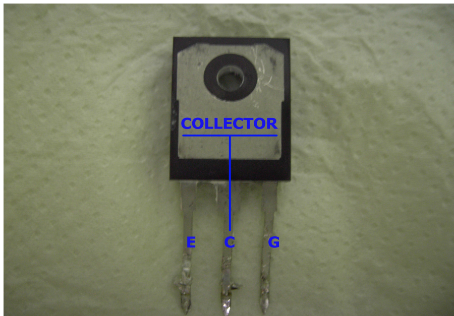
Σχήμα 17 : Η πίσω όψη του IGBT
