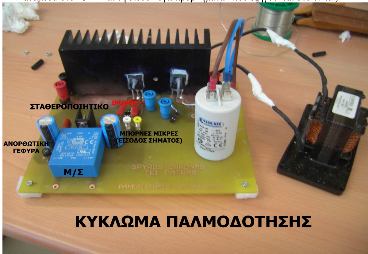
Σχήμα 31β : Τα εξαρτήματα του κυκλώματος παλμοδότησης
