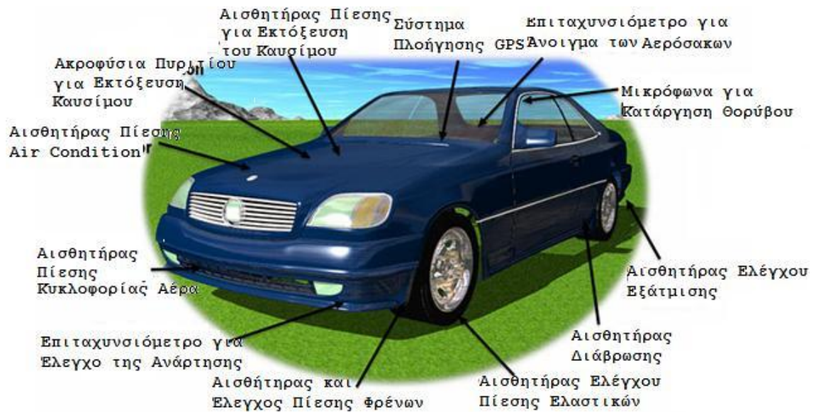
Εικόνα 4-7 : Εφαρμογές των MEMS στα αυτοκίνητα [22].
