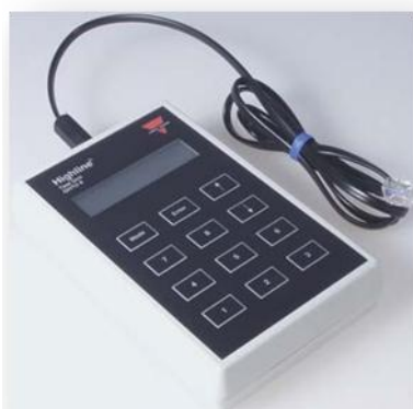
Σχήμα 2.10 Μονάδα ελέγχου απόκρισης καναλιών.
