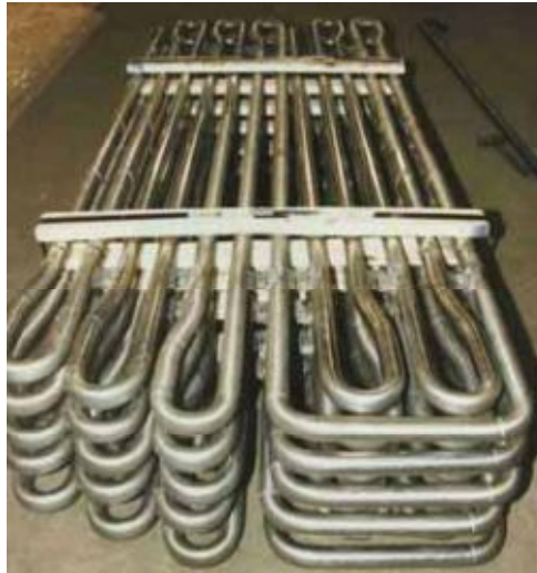
Σχήμα 8. Επιφάνειες ενός συστήματος αγωγών ατμού.
