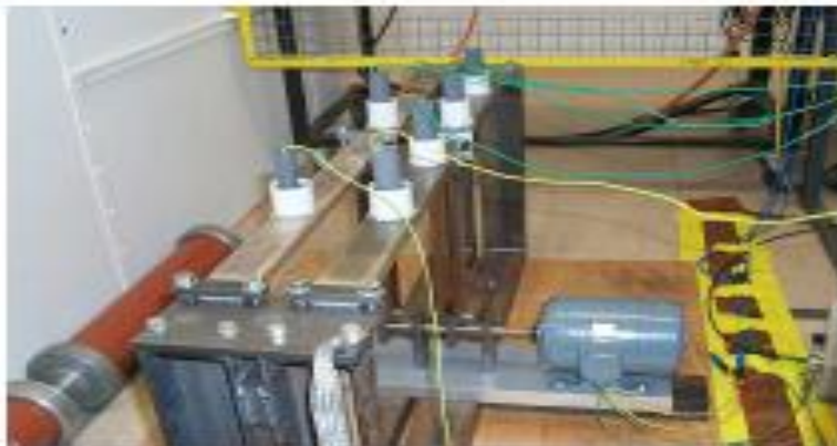
Σχήμα 14. Ο Εργαστηριακός εξοπλισμός που χρησιμοποιήθηκε για την διερεύνηση της επίδρασης των μηχανικών καταπονήσεων στην διηλεκτρική αντοχή.
