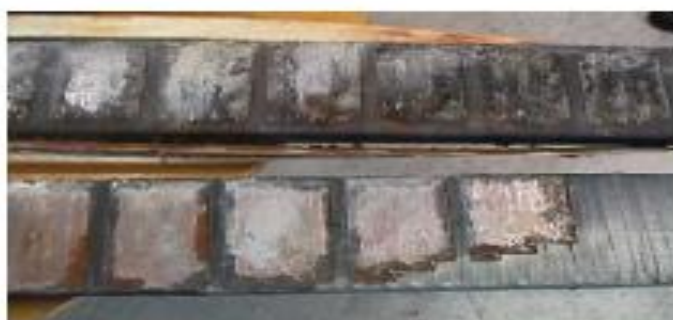
Σχήμα 15. Η τριβή της προστασίας κορώνας αυλακώσεων λόγω κραδασμών.
