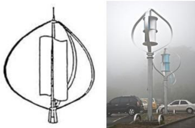
Εικόνα 27 : Ανεμογεννήτρια Darrieus τριών πτερυγίων που χρησιμοποιεί μια ανεμογεννήτρια Savonius δύο πτερυγίων για την εκκίνηση της διαγραμματικά (αριστερά) και σε εφαρμογή στην Taiwan (δεξιά)
