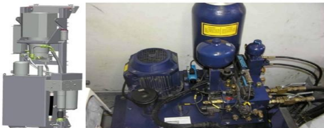
Εικόνα 58: Αντλία χαμηλής πίεσης για θέρμανση του λαδιού (αριστερά πάνω), αντλία υψηλής πίεσης (αριστερά κάτω καλυμμένη) και αντλία φρένων (δεξιά)
