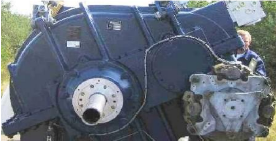
Εικόνα 53: Κιβώτιο ταχυτήτων (μπλε χρώμα) στο οποίο φαίνεται η άτρακτος υψηλής ταχύτητας και το σύστημα φρένων (γκρι χρώμα δεξιά)
