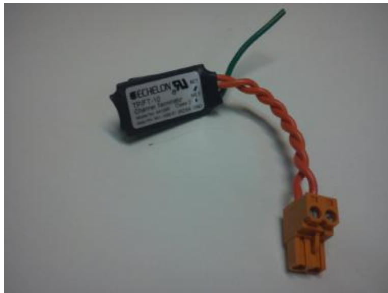
Η τερματική αντίσταση που χρησιμοποιούμε στο δίκτυο LON
