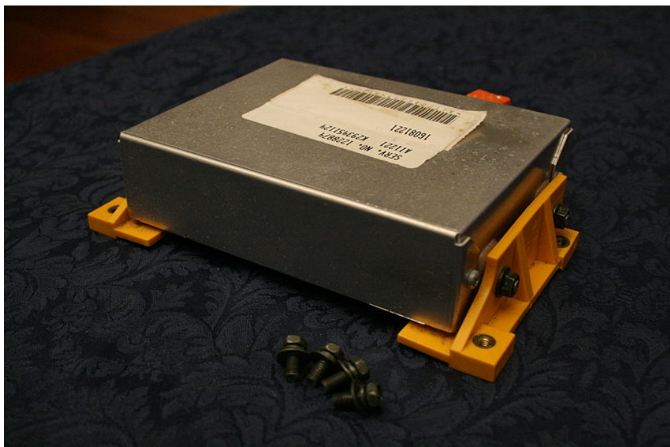
Εικόνα 3.32 : Κεντρική Ηλεκτρονική Μονάδα Επεξεργασίας Αερόσακου.
