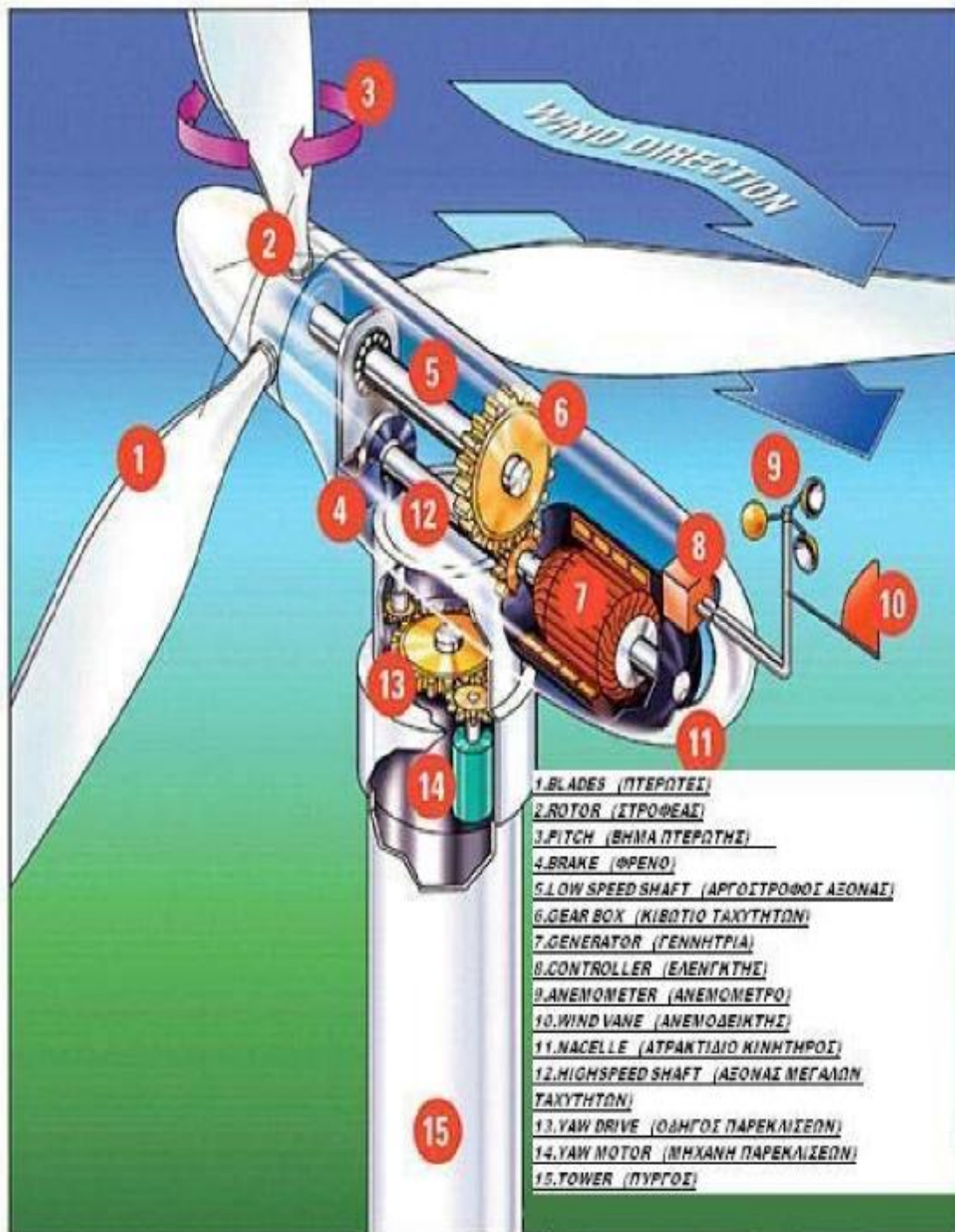
Σχημα 1.4. Τα μηχανολογικά και ηλεκτρολογικά-ηλεκτρονικά μέρη μιας αιολικής μηχανής.
