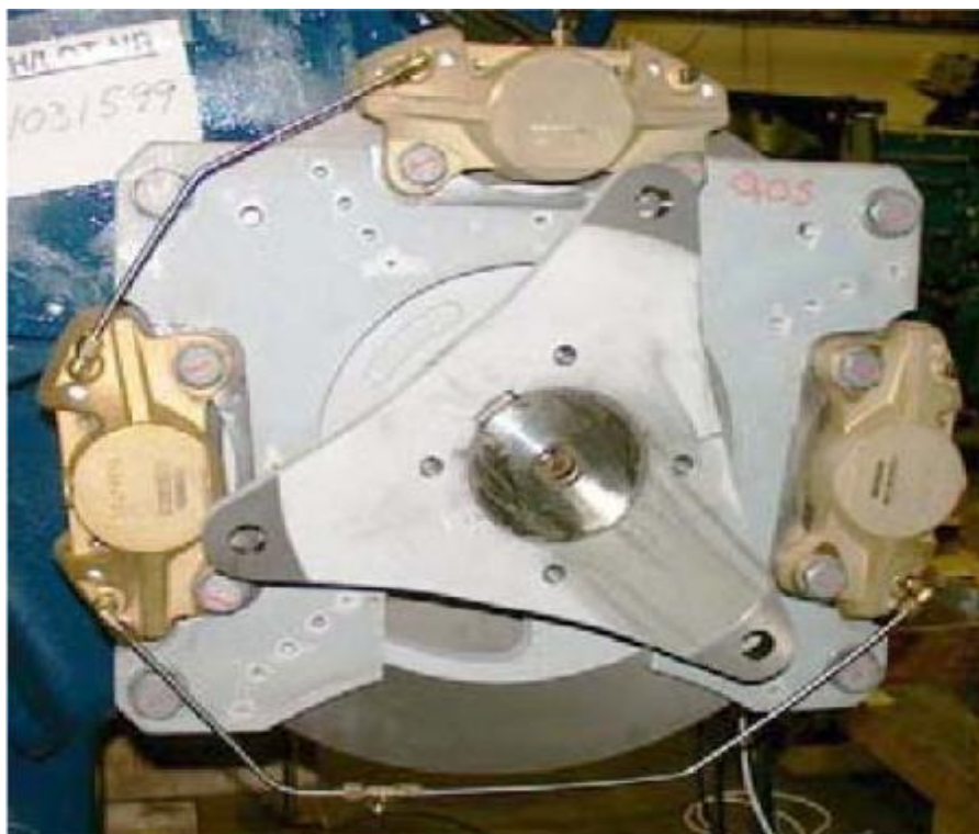
Σχήμα 2.13 Φωτογραφία ολοκλήρου του συστήματος φρένου ,το ποθετημένο στον άξονα σύνδεσης της γεννήτριας.
