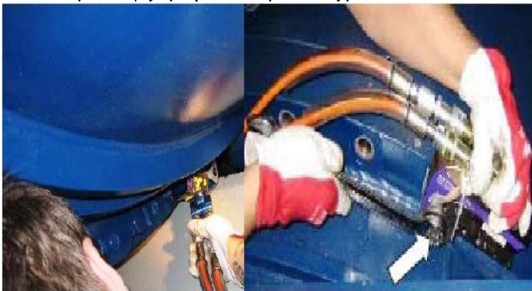
Σχήμα 3.8 Τρόπος χειρισμού του δυναμόκλειδου ανάλογα με το εάν θέλουμε να σφίξουμε η να λύσουμε ένα παξιμάδι.
