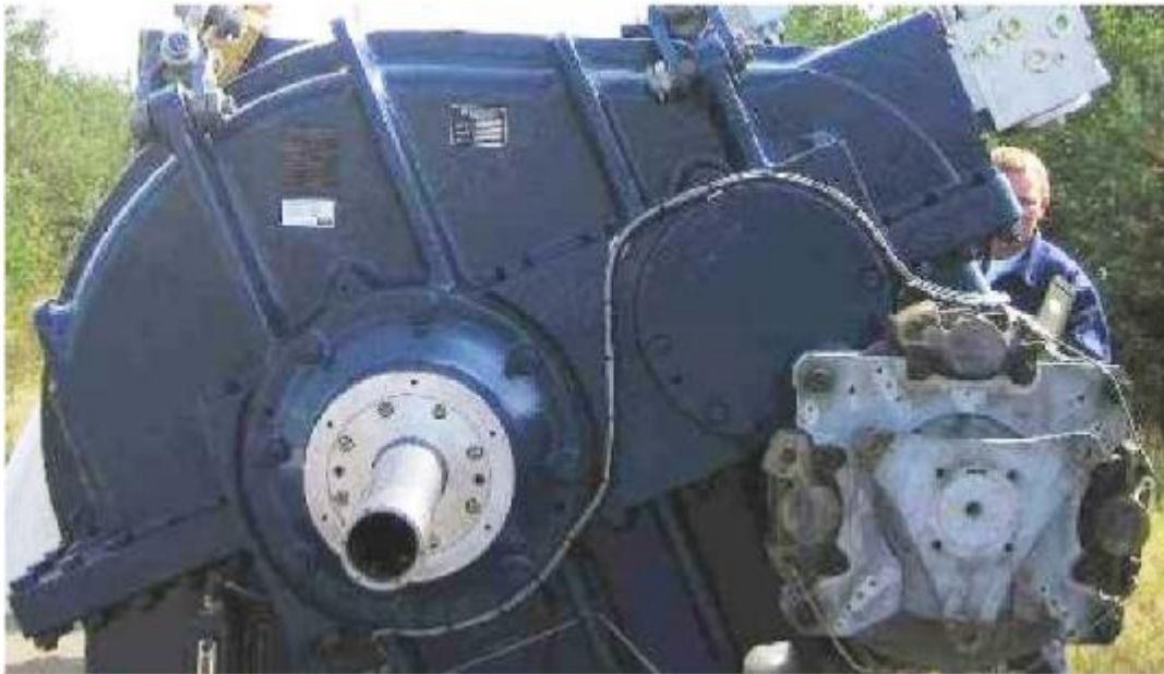
Σχήμα 2.9 Φωτογραφία του κιβώτιου ταχυτήτων του κύριου άξονα και του συστήματος φρένων.
