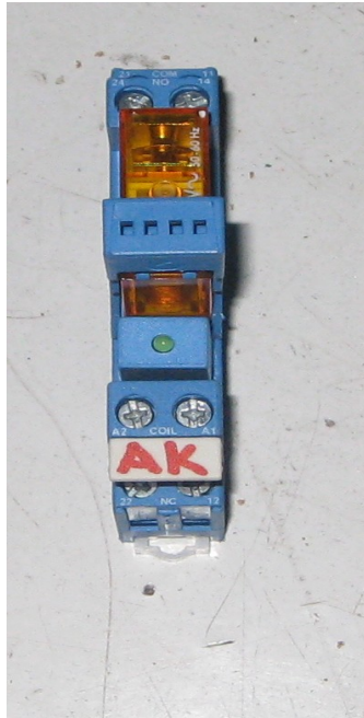
εικόνα 14: ρελαί μηχανισμού απομανδάλωσης θύρας ανελκυστήρα
