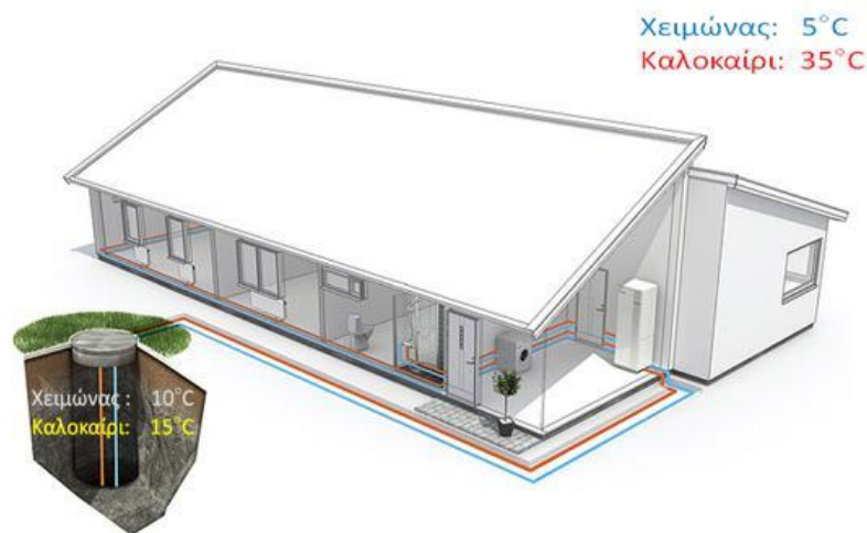
Εικόνα 9.5: Κάθετη διάταξη γεωεναλλάκτη
