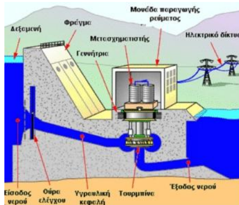
Εικόνα 1.4 : Ενδεικτικό διάγραμμα υδροηλεκτρικού σταθμού
