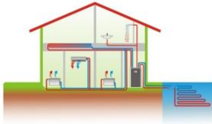
Εικόνα 9.6: Διάταξη γεωεναλλάκτη σε πηγάδι, λίμνη ή θάλασσα
