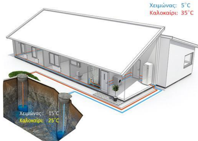
Εικόνα 9.7: Σύστημα ανοικτού κυκλώματος
