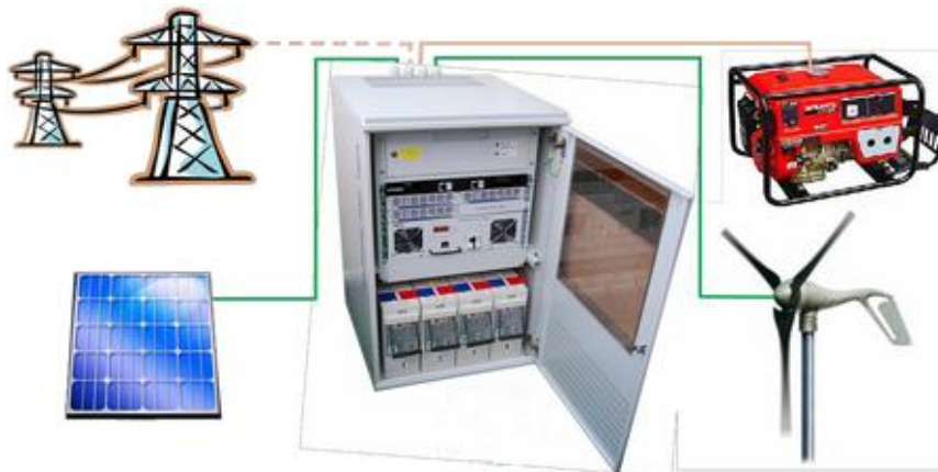
Εικόνα 5.8: Υβριδικό σύστημα συνδυασμού τριών πηγών ενέργειας
