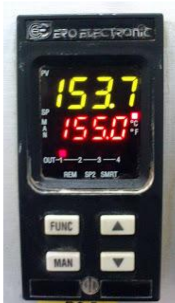
Εικόνα 32:Όργανο ελέγχου θερμοκρασίας Θέλουμε 155 βαθμούς και την στιγμή της φωτογραφίας ήταν 153,7
