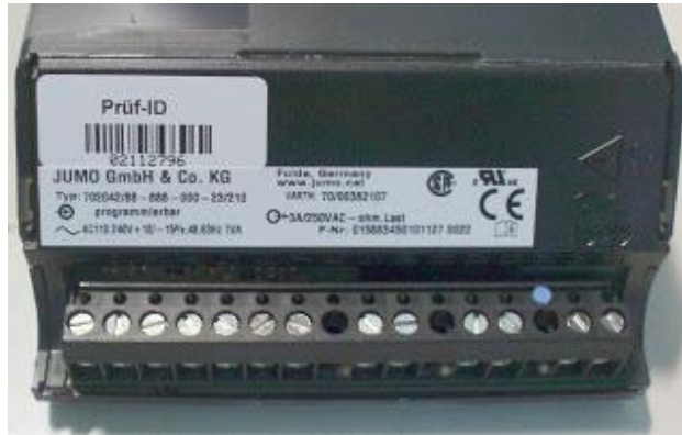
Εικόνα 30: Η πίσω όψη του ελεγκτή όπου γίνονται οι συνδέσεις
