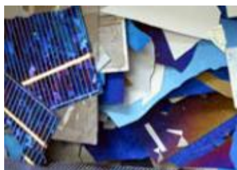
σπασμένα ηλιακά κύτταρα και γκοφρέτες με εκπομπούς και αντι-ανακλαστικές επιστρώσεις
