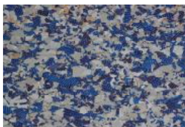
εικόνα cell μετά την απομάκρυνση κουφώματος, μεταλλικού ελάσματος και γυαλιού
