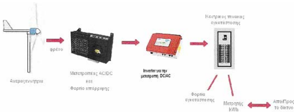
Σχήμα 3.4 Απλοποιημένο διάγραμμα διασυνδεδεμένου συστήματος με ανεμογεννήτρια μικρής ισχύος χωρίς μπαταρίες.
