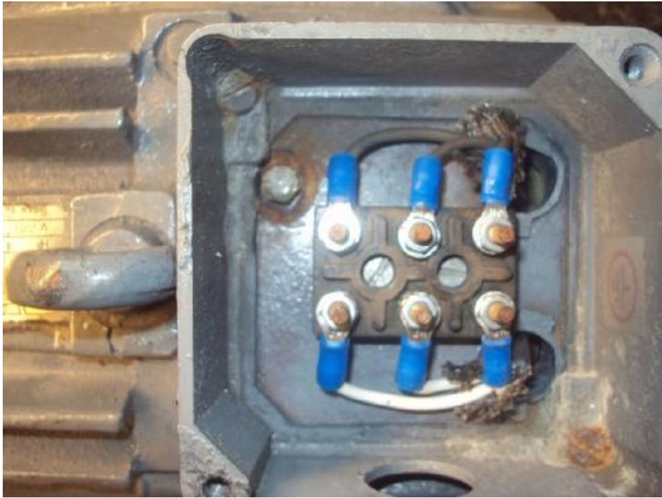
Εικόνα 1 : Διάταξη 6 ακροδεκτών για σύνδεση αστέρα ή τρίγωνο.
