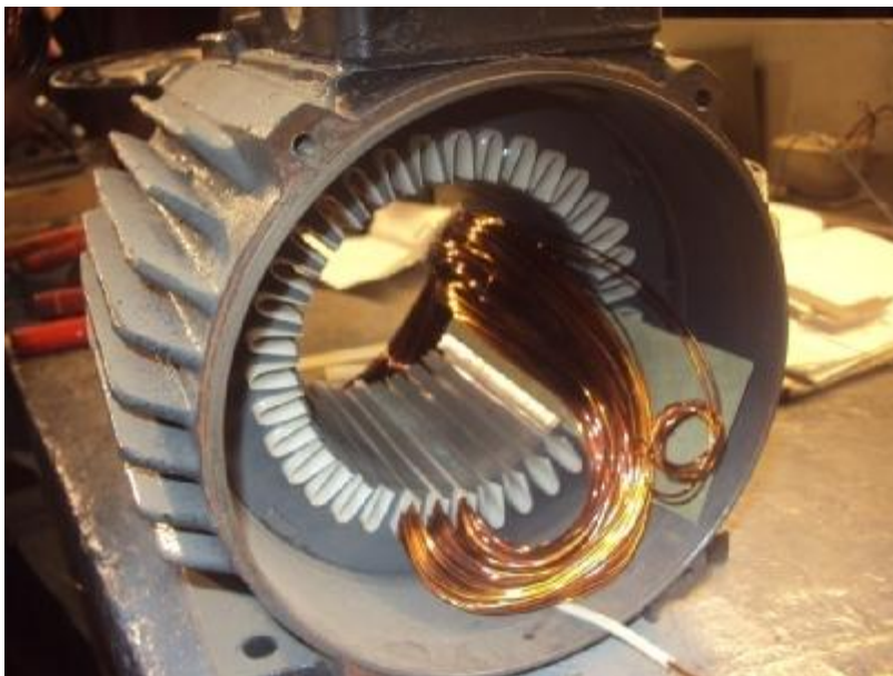
Εικόνα 6 : Η τοποθέτηση της πρώτης ομάδας
