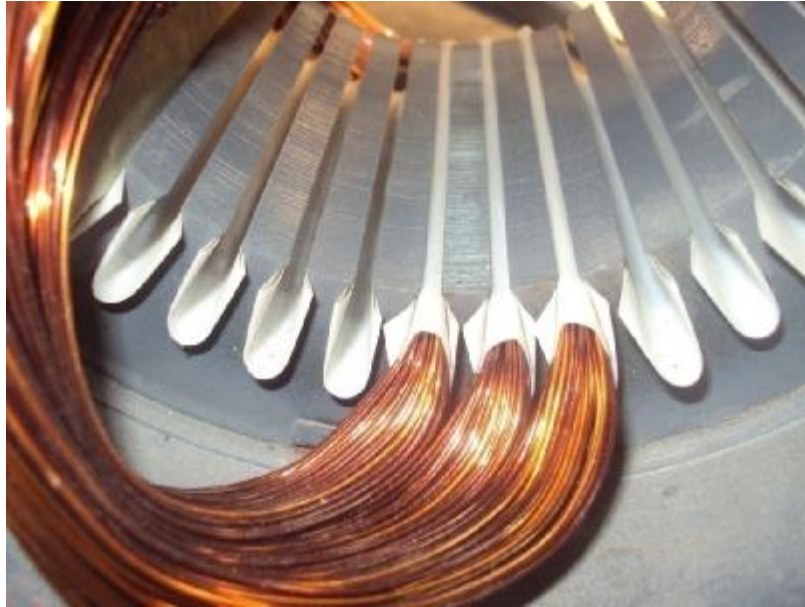
Εικόνα 7 : Λεπτομέρεια των τυλιγμάτων.
