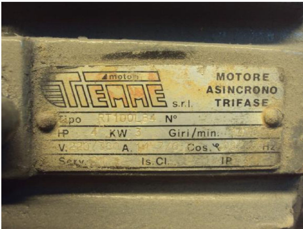
Εικόνα 3 : Ταμπέλα του επαγωγικού κινητήρα.
