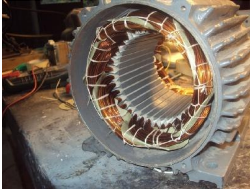
Εικόνα 10 : Δέσιμο των τυλιγμάτων του κινητήρα.
