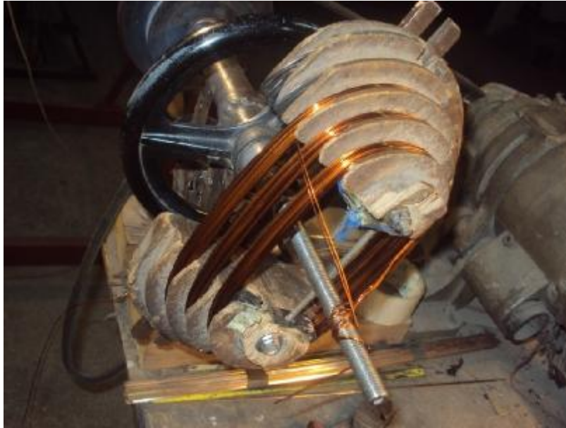
Εικόνα 5 : Κατασκευή των τριών ομάδων στο καλούπι όπου φαίνεται και το ηλεκτρόδιο ρύθμισης του πλάτους των ομάδων.
