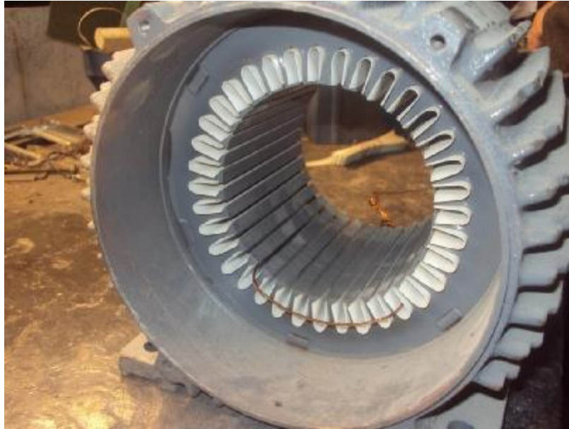
Εικόνα 4 : Εδώ φαίνεται ο πυρήνας του στάτη με τις αυλακώσεις
