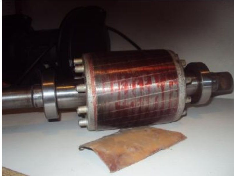
Εικόνα 11 : Ο δρομέας της μηχανής με τοποθετημένα τα καινούργια ρουλιμάν.
