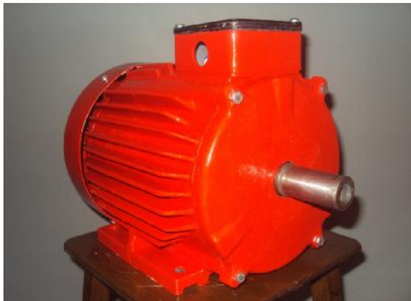
Εικόνα 12 : Ολοκλήρωση της εργασίας με το βήσιμο του κινητήρα.
