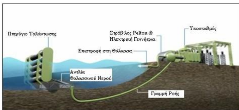
Εικόνα 17: Ολοκληρωμένη εγκατάσταση Oyster™
