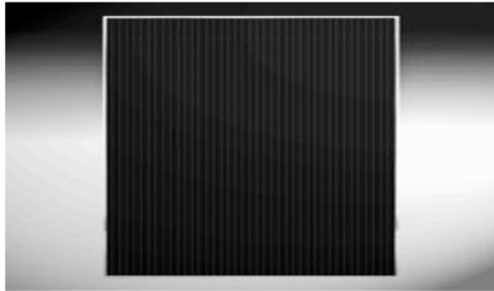
Σχ. 4.1 Πλαίσιο άμορφου πυριτίου
