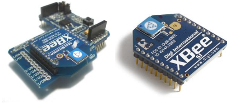
Εικόνα2.8: XBee Shield στα δεξιά και XBee module στα αριστερά.
