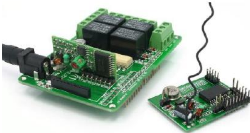
Εικόνα 2.6: Πλακέτα Relay με ενσωματωμένο 315MHZ RF για ασύρματη επικοινωνία.
