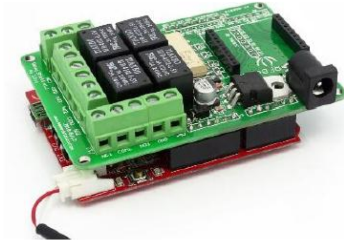
Εικόνα 2.5: Πλακέτα Relay ενσωματωμένη σε πλακέτα Arduino.
