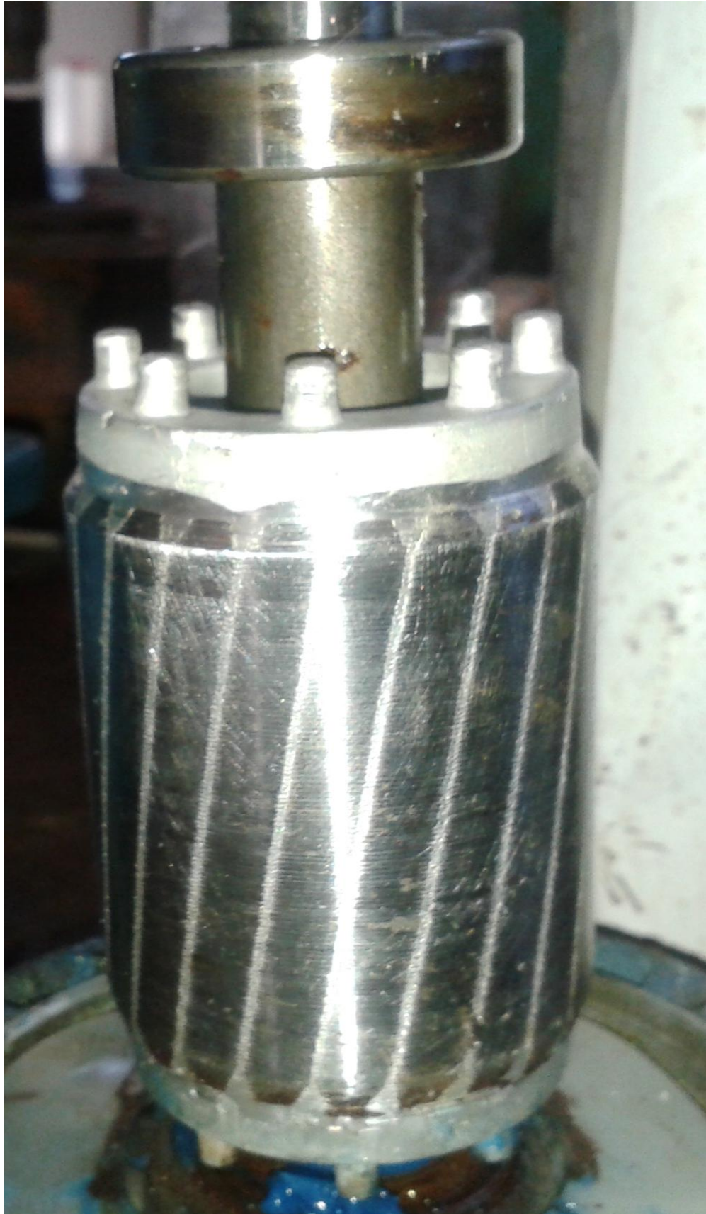
Σχήμα 1.7 Δρομέας τύπου κλωβού (εικόνα από ATK Κλωβού- ΔΕΥΑΜΒ)
