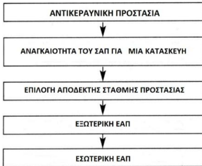
Εικόνα 3. Σχεδιασμός Αντικεραυνικής Προστασίας[11]
