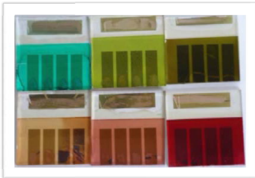
Εικ.ν.13. Ποικιλία χρωστικών ουσιών στερεάς κατάστασης φωτοευαισθητοποιημένων ηλιακών κυττάρων. Πειράματα του Laboratoire Cellules et Composants CEA Saclay στη Γαλλία με απόδοση έως 4%.
