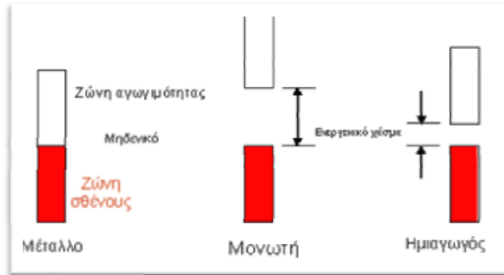
Εικ.ii.11. Διάγραμμα ενεργειακών ζωνών για μέταλλο, μονωτή και ημιαγωγό
