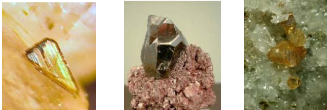
Εικ.ν.8. Κρυσταλλική δομή (α) μπρουκίτης (β) ρουτίλιο (γ) ανάταση
