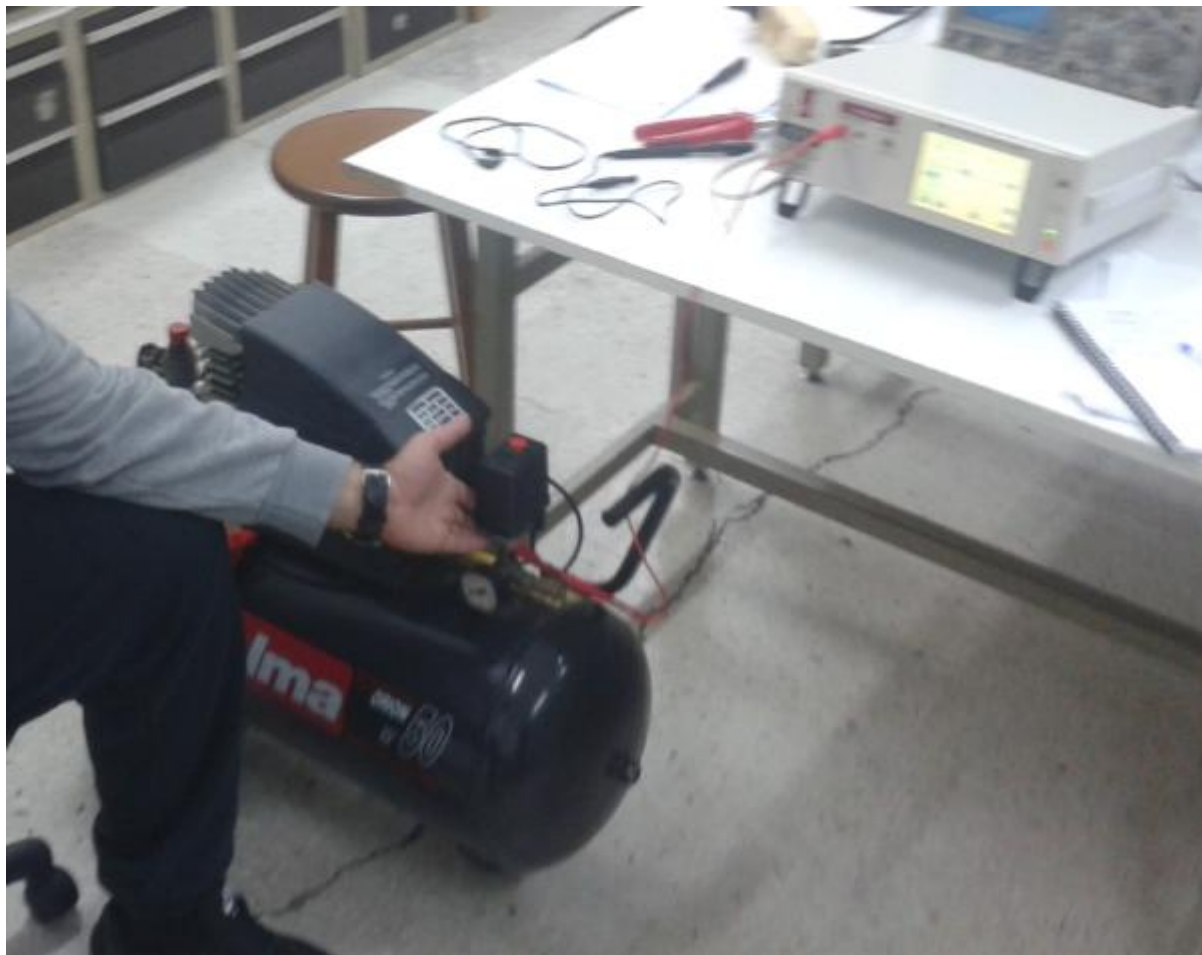
Σχ. 74 (δοκιμή κοφλέρ για θέση "ON" με επαφή χεριού)
