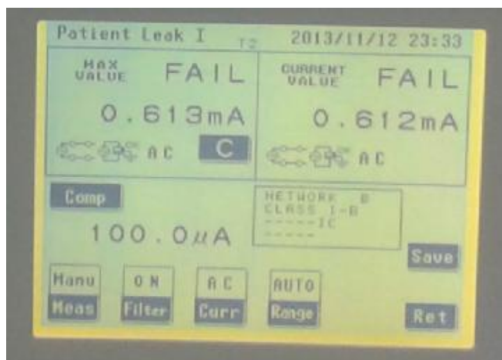
Σχ. 71 (αποτελέσματα δοκιμής τροφοδοτικού για θέση "OFF")
