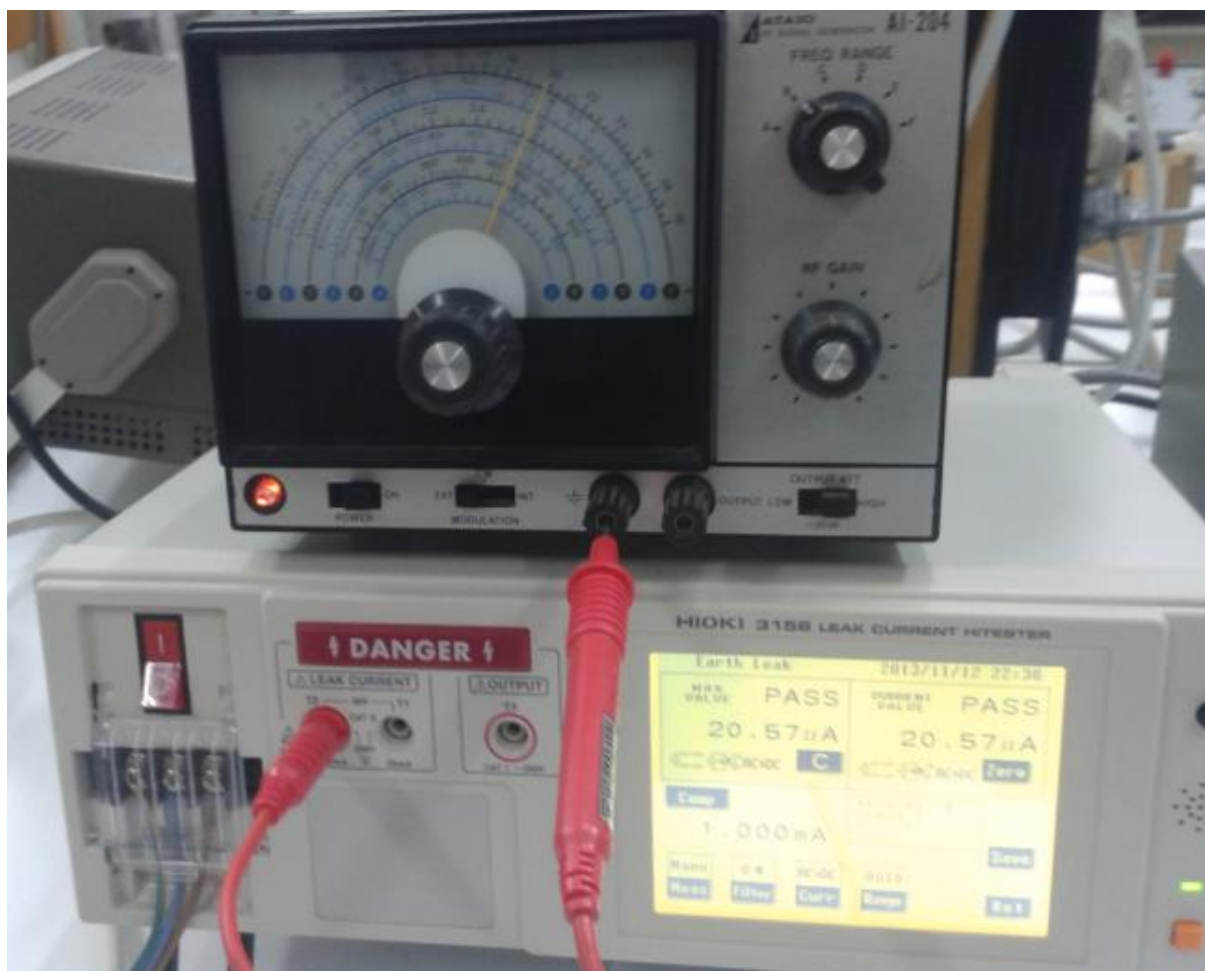
Σχ. 64 (αποτελέσματα δοκιμής γεννήτριας για θέση "ON")
