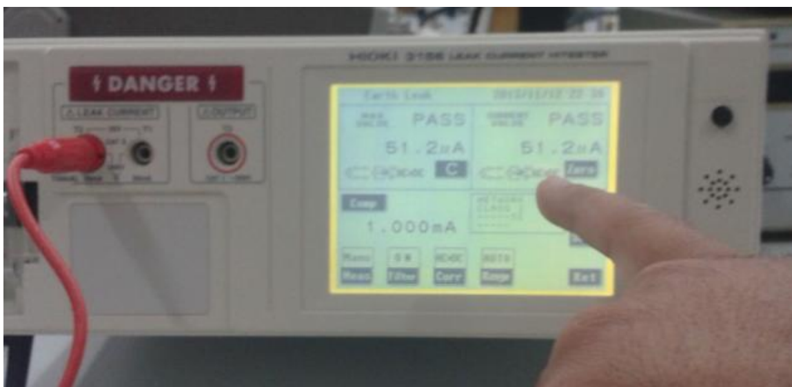
Σχ. 73 (αποτελέσματα δοκιμής κοφλέρ για θέση "ON")
