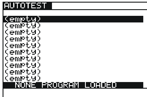
Εικ. 3.4.12.3 Κύριο μενού της λειτουργίας AUTOTEST (αρχικά κανένα πρόγραμμα δεν είναι φορτωμένο)
