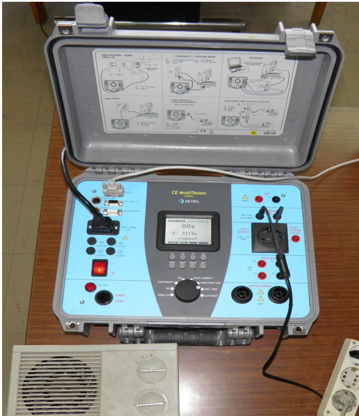
Εικ. 5.3.1 Δοκμή αερόθερμο Error Discharge Time ένδειξη repeat
