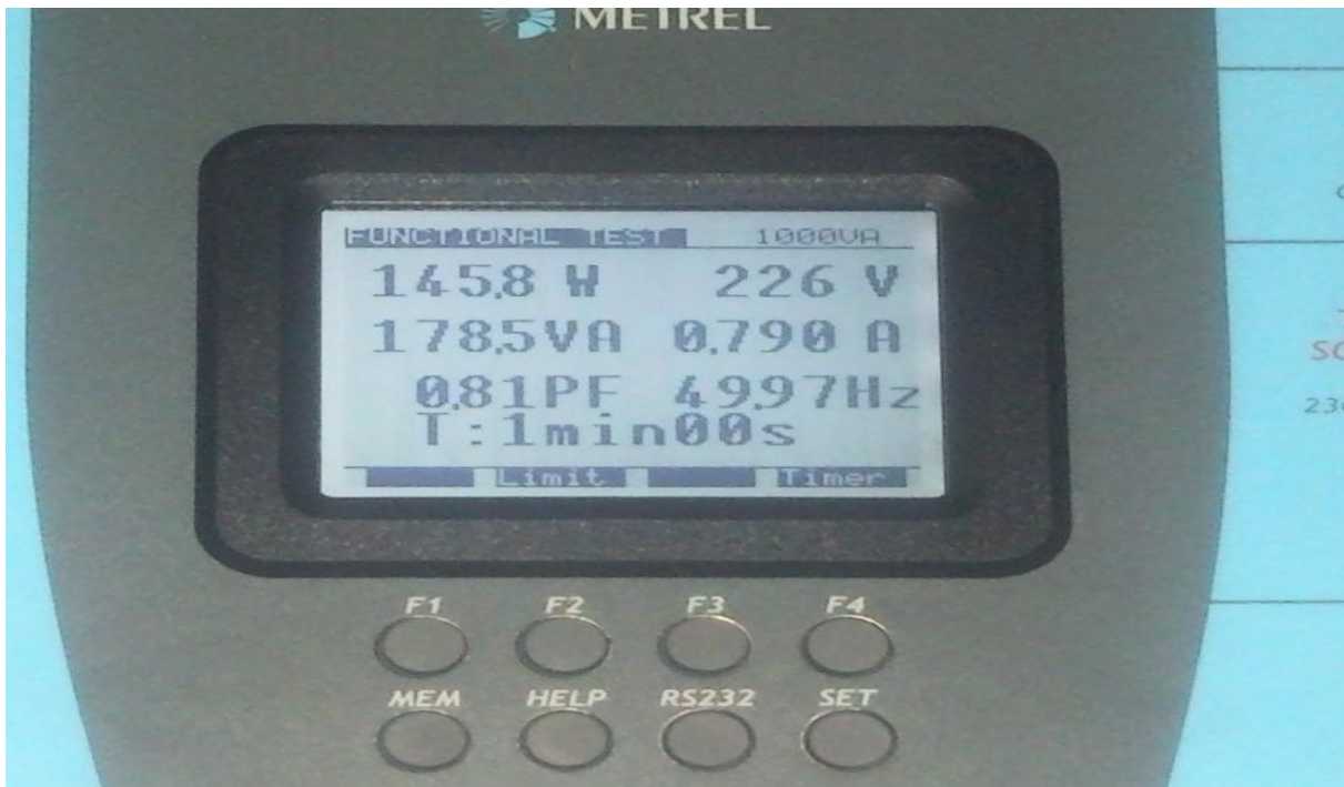
Εικ. 5.4.2 Δοκιμή λειτουργίας ψυγείο Functional Test
