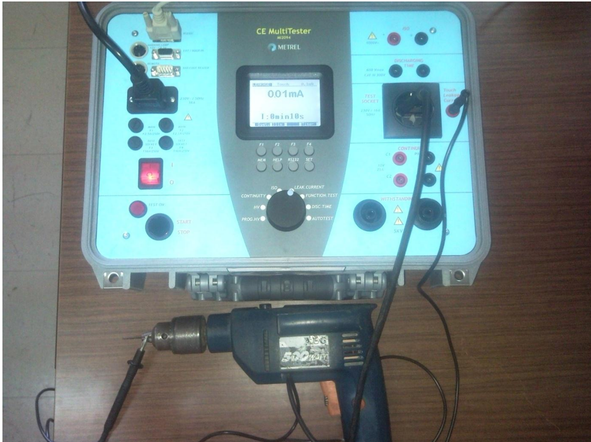
Εικ. 5.2.1 Δοκιμή δράπανο Leakage Current (Touch)
