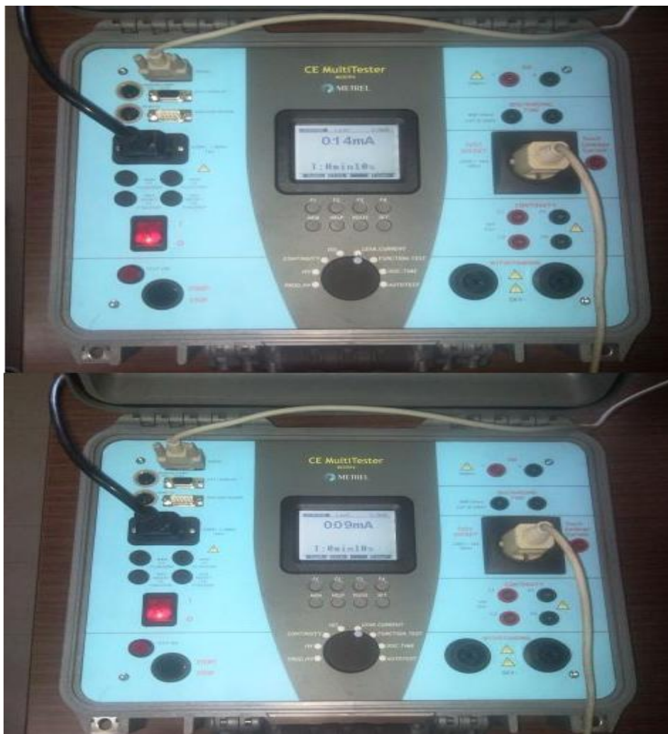
Εικ. 5.1.2 Δοκιμή ψυγείο leakage Current
