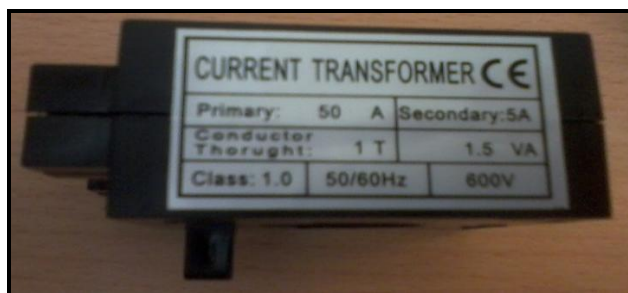
Σχήμα 4-6 Χαρακτηριστικά μετασχηματιστή έντασης.
