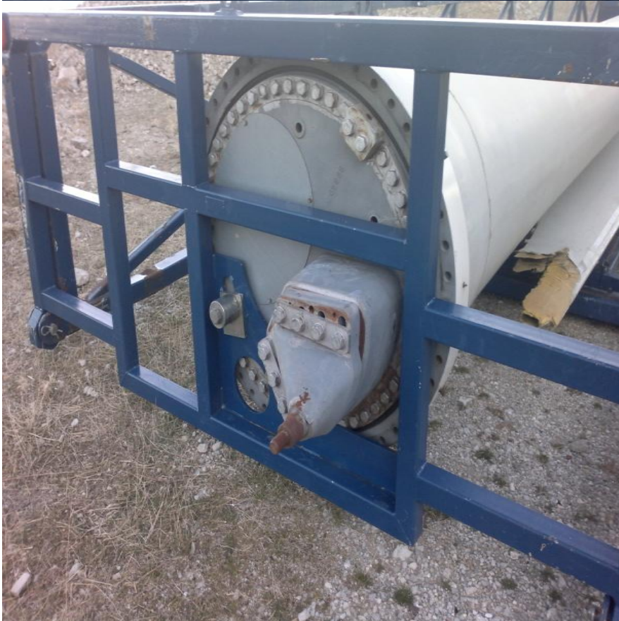
Εικόνα 5.3.6 Φτερά και σημείο διασύνδεσης του με το hub.
