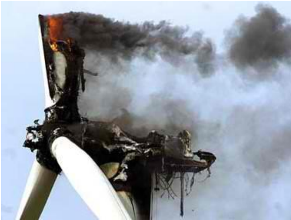
Εικόνα 5.5.2 Καμένο φτερό από κεραυνό.
