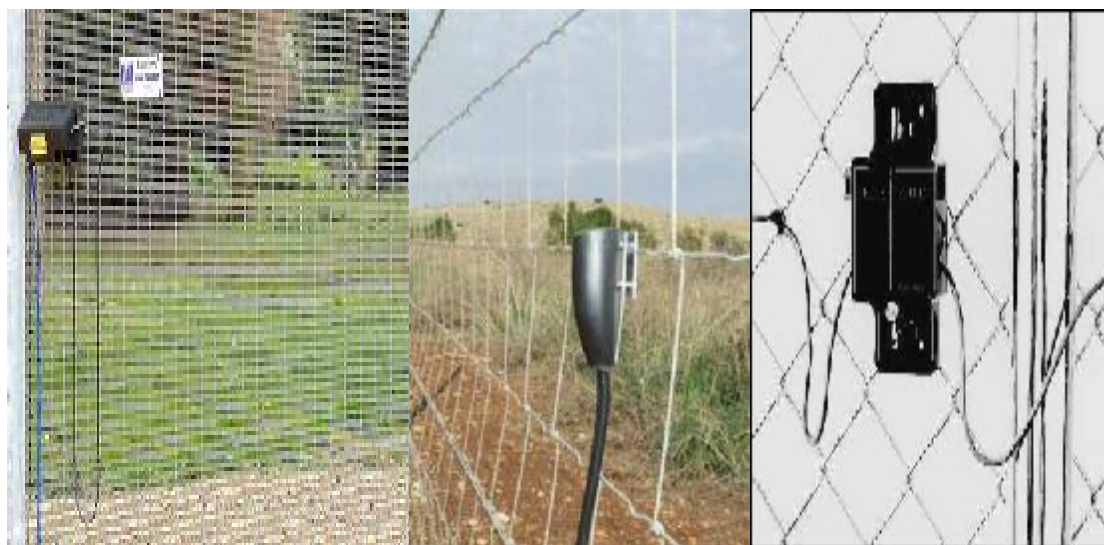
Εικόνα 278: Αισθητήρες δόνησης σε φράκτη
