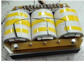
Εικόνα 1-4. Τριφασικοί μετασχηματιστές : α.) τύπου πυρήνα με συγκεντρικά τυλίγματα, β.) τύπου μανδύα με δισκοειδή τυλίγματα. [28]
