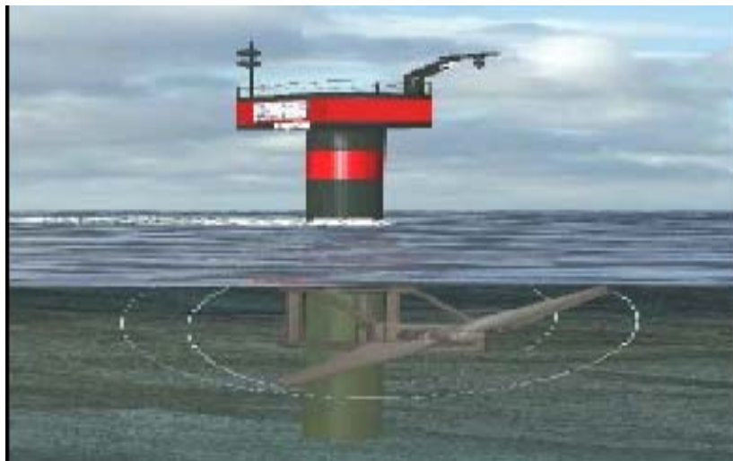
Σχήμα 4.35 Φωτογραφία ενός πυλώνα πακτωμένου στον πυθμένα της θάλασσας όπου πάνω του προσαρμόζετε ρότορας οριζοντίου άξονα.
