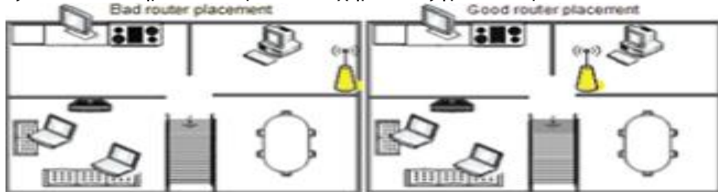
Εικόνα: Λανθασμένη τοποθέτηση του Router(αριστερή εικόνα) και σωστή τοποθέτηση του Router(δεξιά εικόνα) μέσα σε εσωτερικό χώρο
